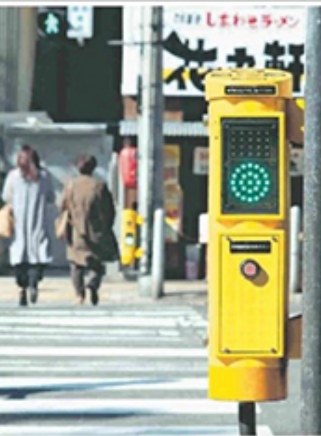
大阪市内に設置されている盲ろう者用の信号補助装置(篠原電機提供)
