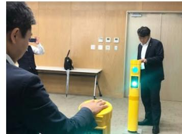
補助装置の上部は、点字で上下左右の行き先表示がされているほか、信号の色に連動して振動する機能を備えており、視覚障がい者が手で触れることで信号機の「青」「点滅」「赤」を認知することが出来る。
