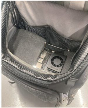
図2 小型のエッジ AI にて構成
