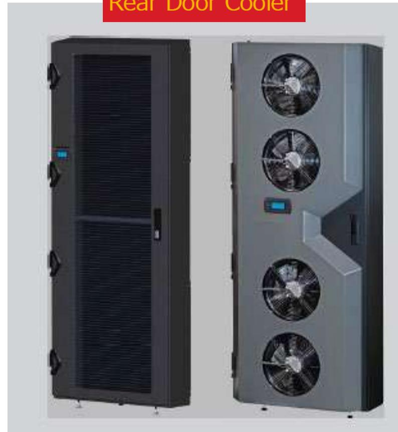
Rack裏扉と交換した冷却用熱交換器でサーバ排気熱を吸収。高温になるのはサーバ排気口からリアドア熱交換器までの数十cmのみ。ラック外部には熱が一切出ない。冷却は水を使用し、一般的にはリアドアの下部にフレキシブル配管を行う。当然リアドアの開閉は自由である。リアドアを開けメンテ中は1ラック分の熱が室内放出するが、その分は他のリアドアが吸収するので影響は少ない。30-75kw/Rackが市販されている。
