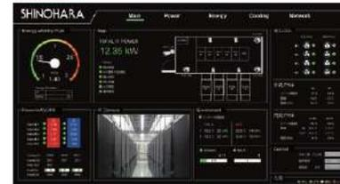
ファシリティ設備監視のダッシュボードとしてリアルタイムPUE値 / 温度度 / 各ラックのIT負荷状況/IPカメラのリアルタイム映像を表示します。
