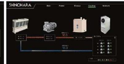
冷却設備の運転状態と配管内水温を表示します。機器の異常停止および故障信号を受信した際は、メール発報のほか、赤信号表示に切り替わります。
