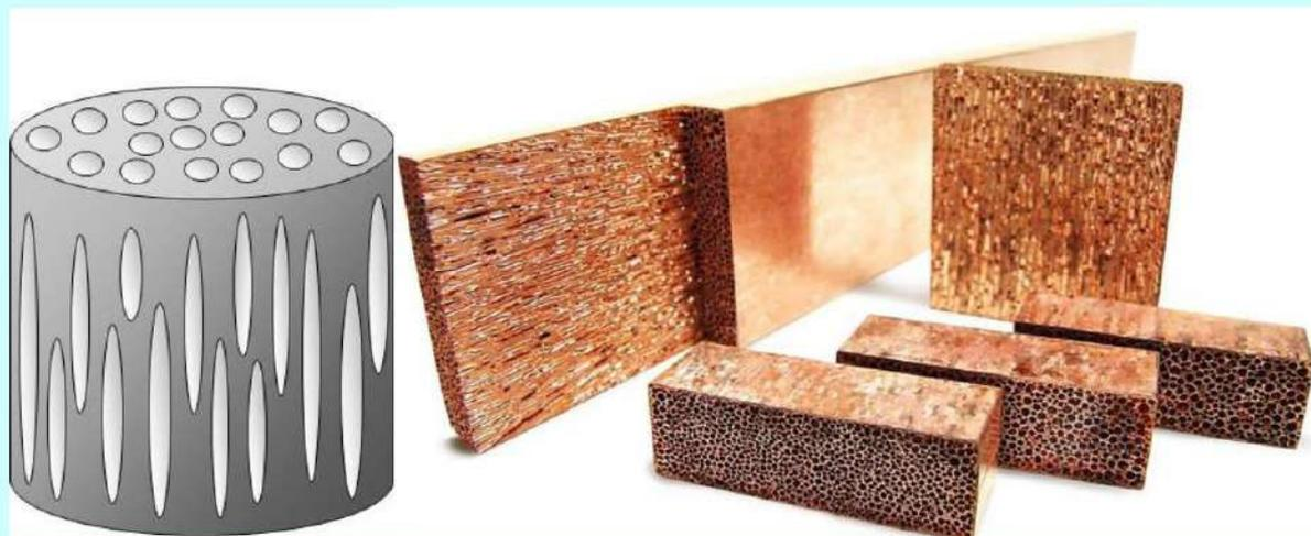
ロータス金属:一方向に伸びた気孔を有する
