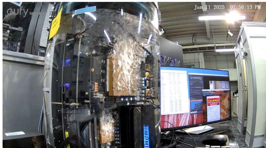
CPU,GPUのチップをそのまま液浸に装着しても、49°Cの沸点からしか沸騰できない。また沸騰曲線があり、ある発熱を超えると膜沸騰から核沸騰になり冷却性能が低下する。
