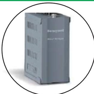
Midasパイロライザーはマイダス本体と組み合わせて使用頂くと三ッ化窒素やフロン類ガスを熱分解しHFセンサーで検知させる機器です。(NF3, C4F6, C5F8, CH2F2, CH3Fなど)
