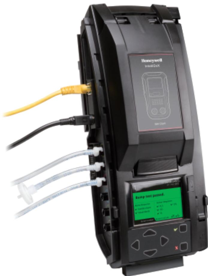
**IntelliDoXはBWポータブルガス検知器の点検・校正を簡単に、コスト効率良く、素早く行なうことができます。**
