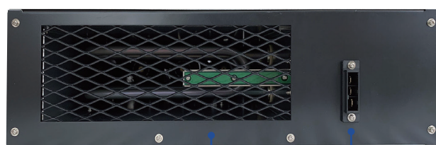
排気口 電源ケーブル接続コネクタ
