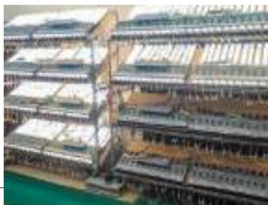
■恒温恒湿槽による動作温度・動作湿度試験の様子
