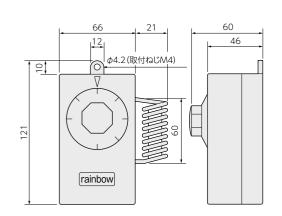
スペースヒーター、換気ファンなどに接続し、盤内の温度制御にご使用ください。
