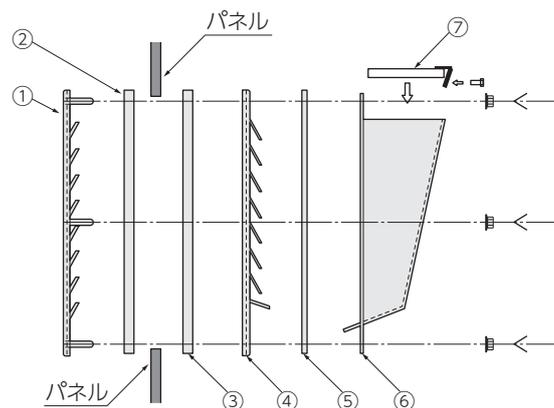
⚠ 注意・締付ナットは均等に締め付けてください。適正締付トルクは1.96N・m(20kgf・cm)です。
