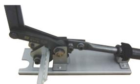
据置台を用いることでDINレールカッターが自立しますので作業性が向上します。
