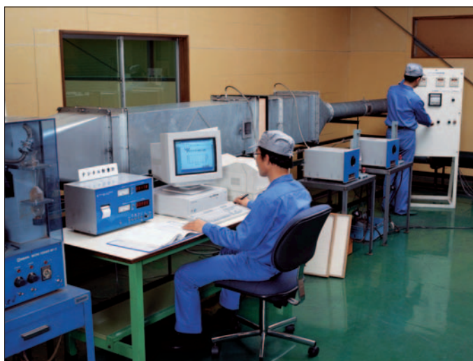
★比色法（JIS B 9908 形式2）試験装置
