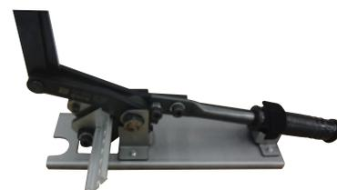
据置台を用いることでDINレールカッターが自立しますので作業性が向上します。
