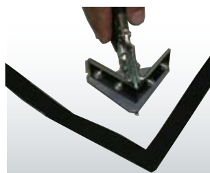
③パッキン貼付け
