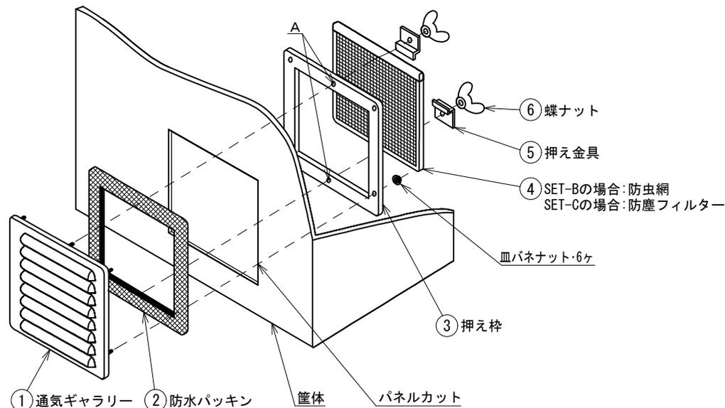
通気ギャラリ-①、防水パッキン②を筐体外側より、押え枠③を筐体内側よりはさみ込むようにして、付属の皿パネナットで取り付けて下さい。
