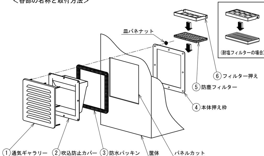
通気ギャラリ(①)、吹込防止カバー(②)、防水パッキン(③)をセットして筐体外側より吹込防止カバーのフード部分をパネルカット角穴内に挿入し、筐体内側より本体押え枠(④)で取付面をはさみ込んで下さい。その後、付属の皿バネナットで確実に固定して下さい。最後に吹込防止カバー(②)上面の通風口に防塵フィルター(⑤)、フィルター押え(⑥)をはめ込んで取り付けて下さい(耐塩フィルター取付の場合、フィルター押え(⑥)のはめ込む方向が逆さまになります)。
