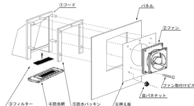
フード(①)にフィルター(③)、防虫網(④)を付属のビスを使用して順に取り付けて下さい。
