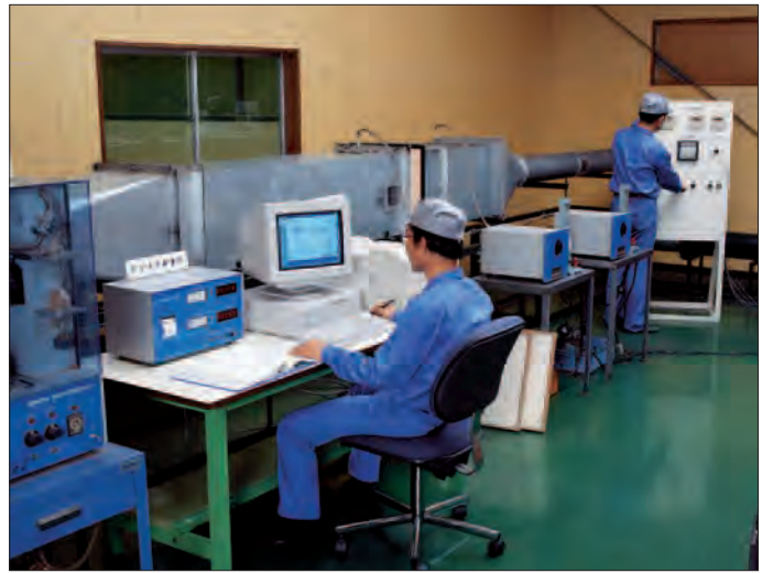
★比色法 (JIS B 9908 形式2) 試験装置
